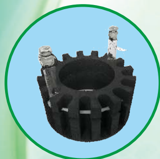
16位试管固定器 (适用30 mL 具塞比色管)
